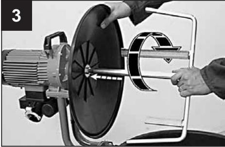
Introduzcan la cubeta en el bastidor inferior prestando atención en colocar uno de los cuatro mangos de transporte en la lengüeta metálica a tal efecto.
