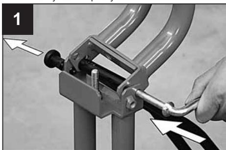
Вставить все детали в порядке, указанном на рис. 2, и зафиксировать все шестигранным ключом 22 мм из комплекта поставки.
