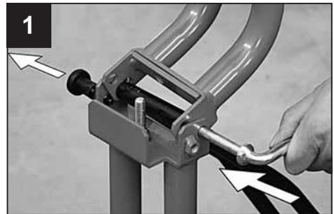
Die Komponenten entsprechend der in Abbildung 2 dargestellten Reihenfolge einsetzen, dann alles mit dem mitgelieferten 22-mm-Inbusschlüssel festziehen.
