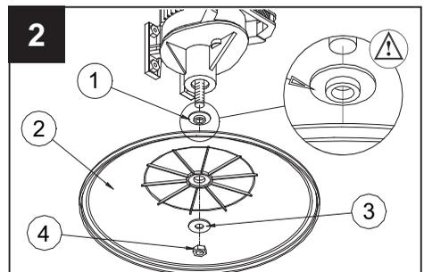
Das Rührwerk fest an den Motorkörper schrauben.
