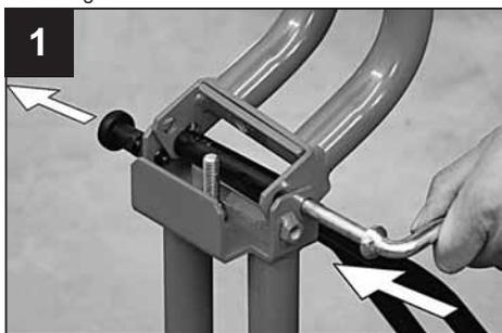
Introduire, en séquence, toutes les composantes comme indiqué sur la fig. 2 et bloquer l'ensemble en agissant sur l'écrou au moyen de la clé pour vis à six pans 22 mm fournie avec l'appareil.
