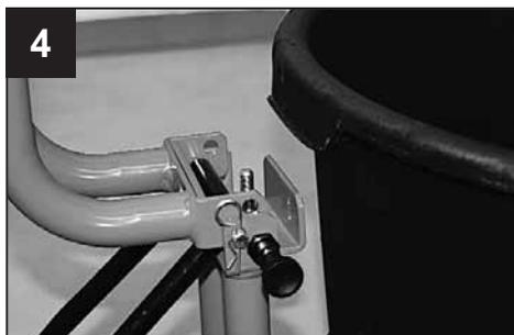
Вставить мешалку, как показано на рис. 5. Опустить головку двигателя в рабочее положение.
