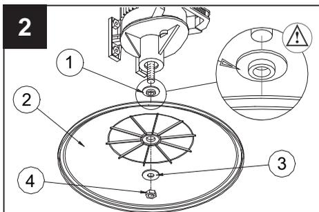
Enrosquen a tope el agitador sobre el cuerpo del motor. El bloqueo definitivo tendrá lugar cuando se ponga en marcha la máquina.
