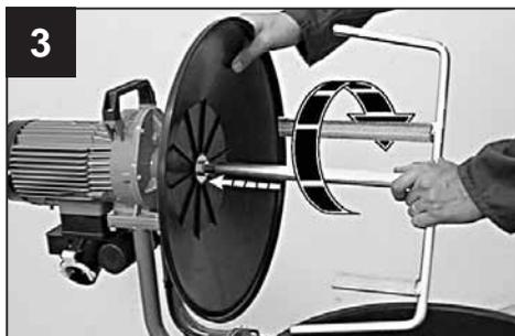
Inserite il secchio nel telaio inferiore avendo cura di alloggiare una delle quattro maniglie di trasporto nella linguetta metallica predisposta.
